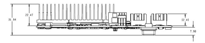
Figure 3. Intel® RMSP3AD160F RAID module dimensions
