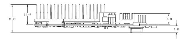
Figure 9. Intel RMSP3HD080E RAID module dimensions
