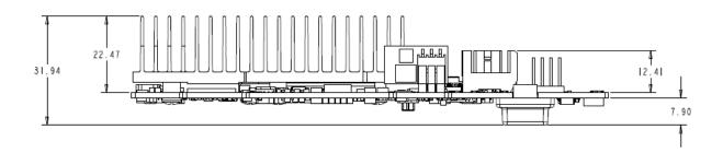
Figure 6. Intel® RMSP3CD160F RAID module dimensions
