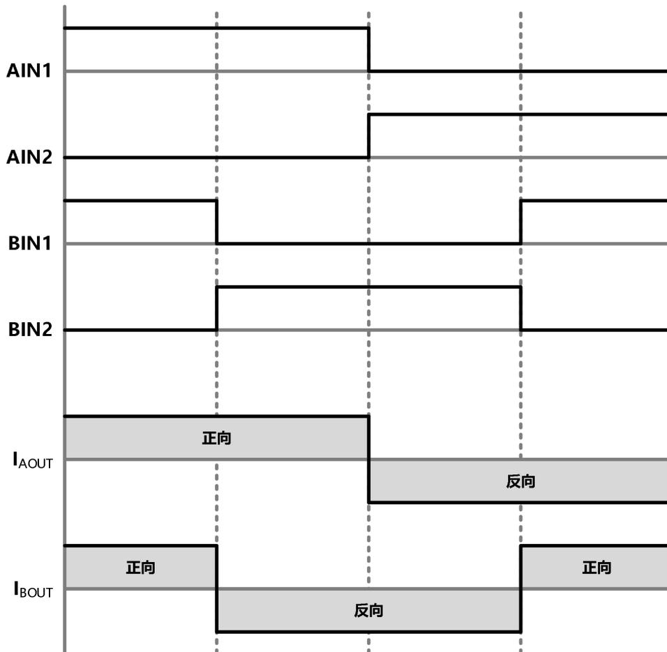
整步控制时序(4-pin 输入模式)
