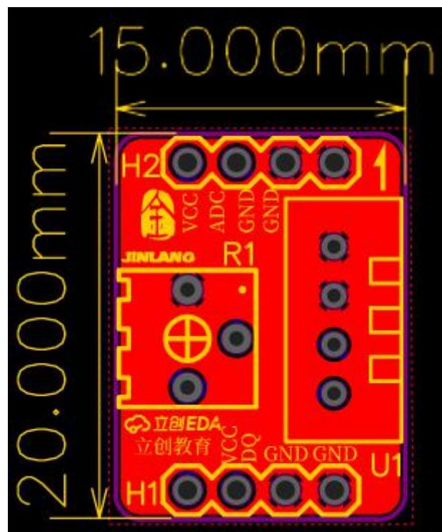
VCC：该模块的供电电压为 3.3V，由开发板进行供电；
