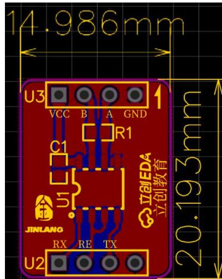
VCC：该模块的供电电压为 3.3V，由开发板进行供电；
