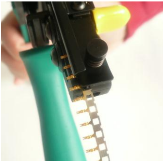
Inserted strip of contacts. Eingelegter Kontaktstreifen.
