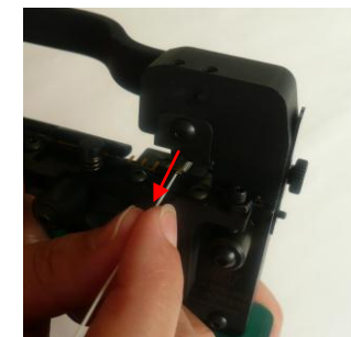
Remove the contact. Kontakt entnehmen.
