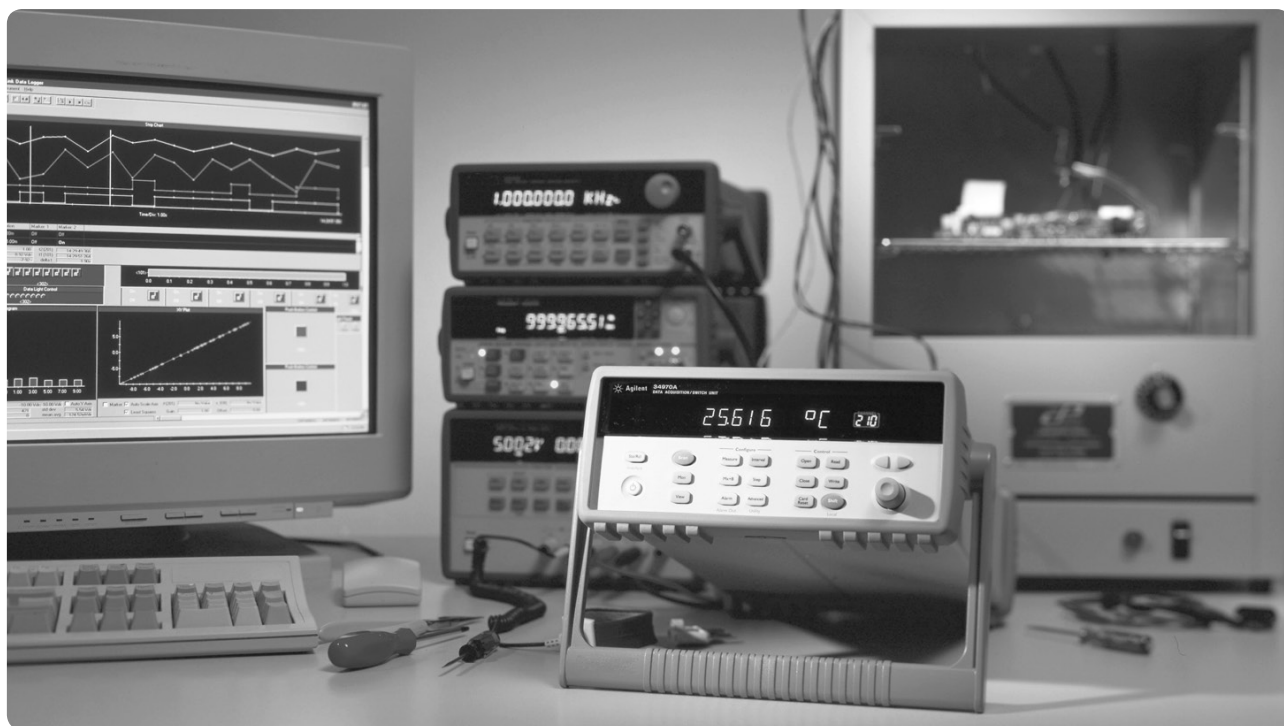
Sistema compacto de adquisición de datos de 60 canales
