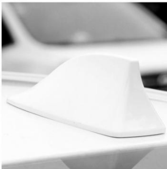
第四步：安装原车线位置，压实，安装完毕
