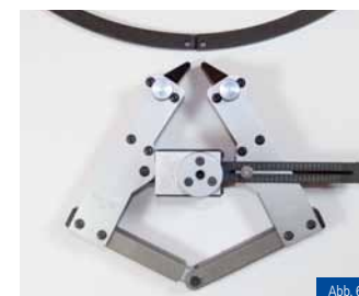
Abb. 6 Positionieren und Einsetzen: vorbereitetes Werkzeug in Position zum Sicherungsring bringen und Werkzeug in die Bohrungen des Sicherungsringes einsetzen
