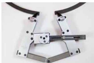
Abb. 9 Gelöster und frei liegender Sicherungsring
