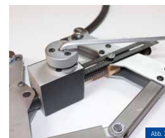
Abb. 7 und Abb. 8 Lösen des Sicherungsringes: Mit beigelegtem gebogenen Innensechskantschlüssel 5 bzw. mit dem in eine passende Maschine eingesetztem sechskant – Bit 6 mm (für maschinelle Verstellung) 6 in der Öffnung des Einstellrades 4 Werkzeug soweit öffnen, dass der Sicherungsring von der Welle oder aus dem Zylinder entnommen werden kann
