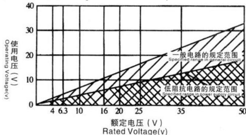
使用低阻抗电路时，请将使用电压设定在额定电压的 1/3 下，使用其他电路时，如上图所示，请将使用电压设立在额定压的2/3以下。
