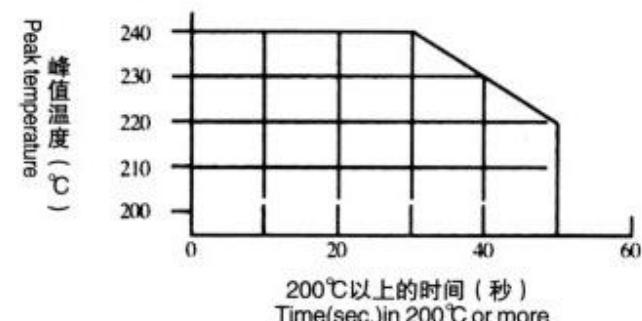
使用热源接触法（热板法）或汽相焊接法等其他方法进行焊接时，请确定并商谈。如焊盘比端子面大得过多，焊锡融化时可能引起错位。
