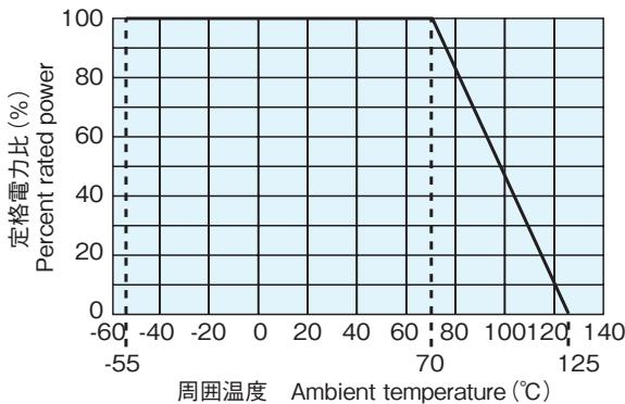
周囲温度70°C以上で使用される場合は、左図負荷軽減曲線に従って、定格電力を軽減して御使用ください。
