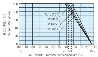
超过上述端子部温度使用时,请根据负荷减轻特性曲线减小额定功率后使用。 ※ 关于使用方法,请参照卷首的"端子部温度负荷减轻特性曲线的说明"。
