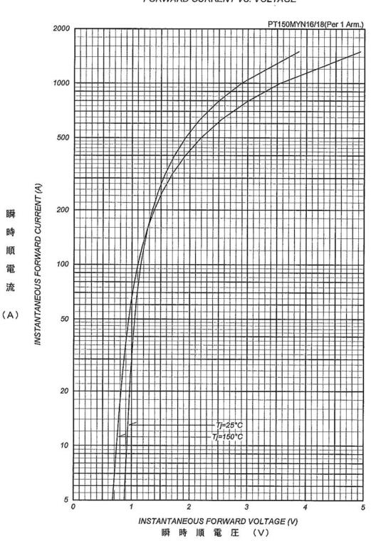
順電圧特性 FORWARD CURRENT VS. VOLTAGE
