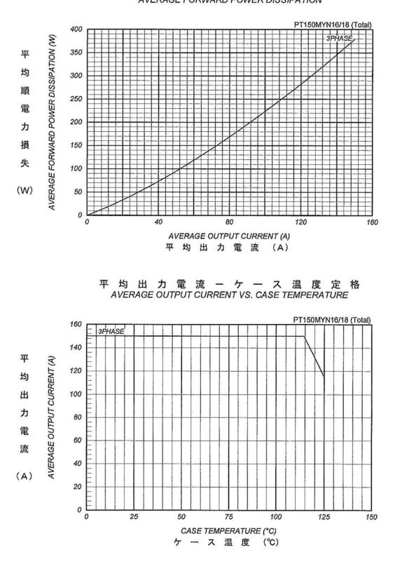
平均順電力損失特性 AVERAGE FORWARD POWER DISSIPATION
