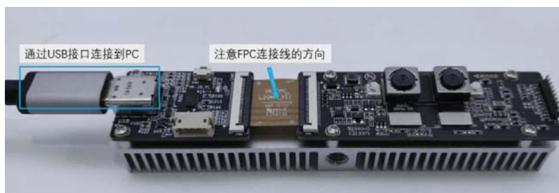
图 2.2 连接 VisionSeed 到电脑 USB 接口
