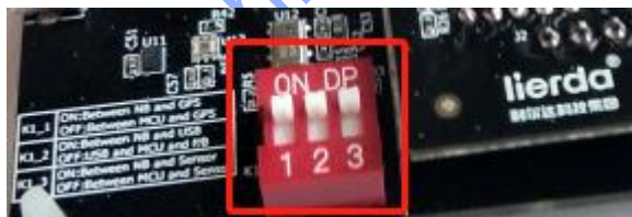
图 3-1 NB86-G 模组烧写固件拨码开关示意图
