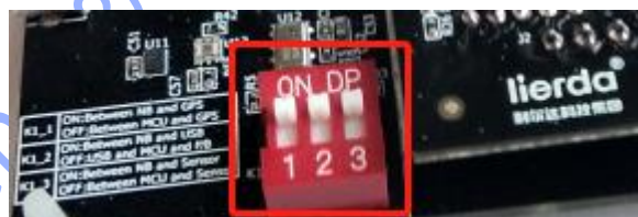
图 2-3 NB86-EVK-A 板模拟水表拨码开关示意图
