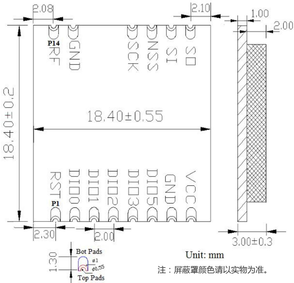
图 3-2 LSD4RF-2F717N30 模块外形尺寸图
