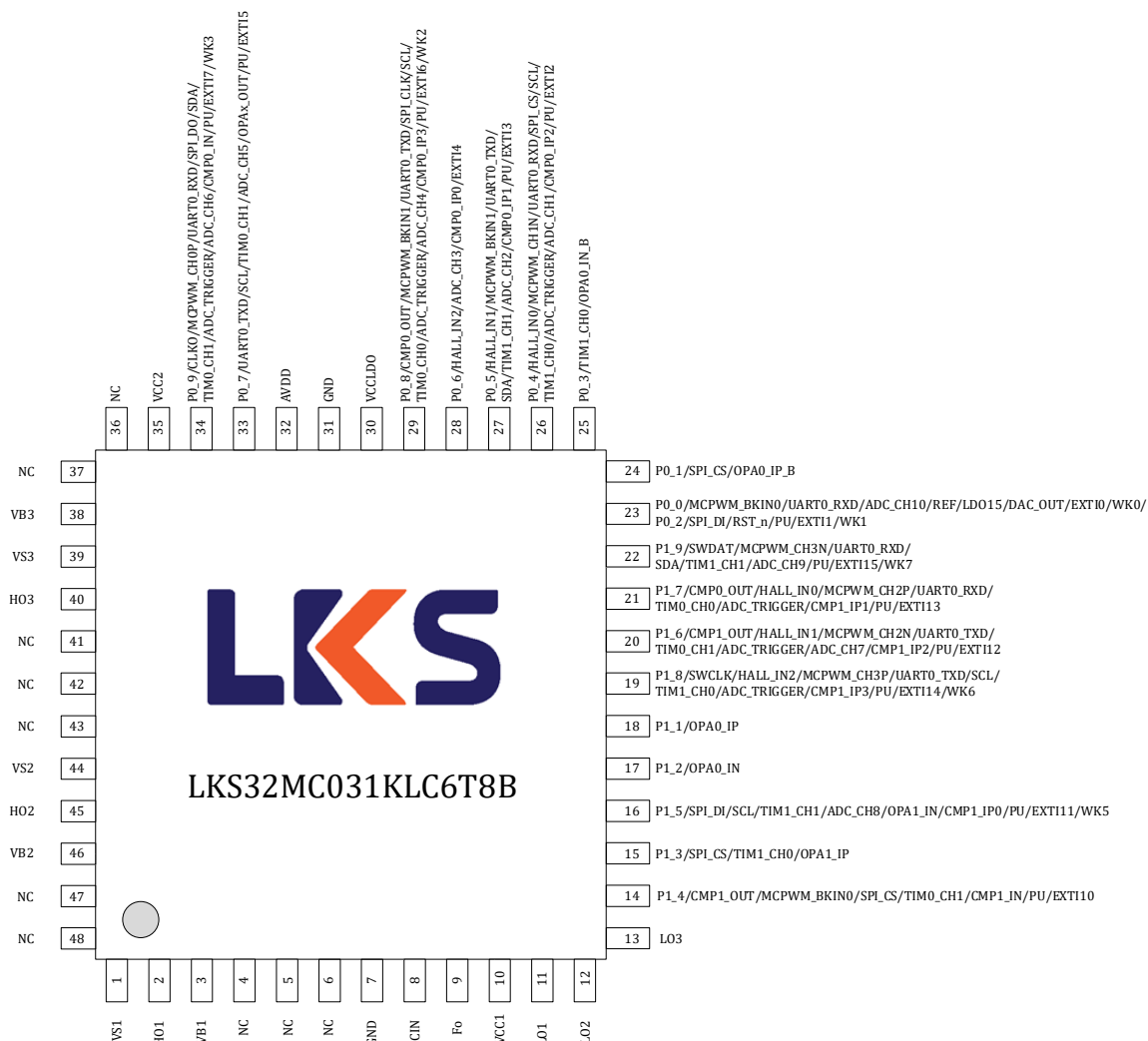
图 3-1 LKS32MC031KLC6T8B 管脚分布图
