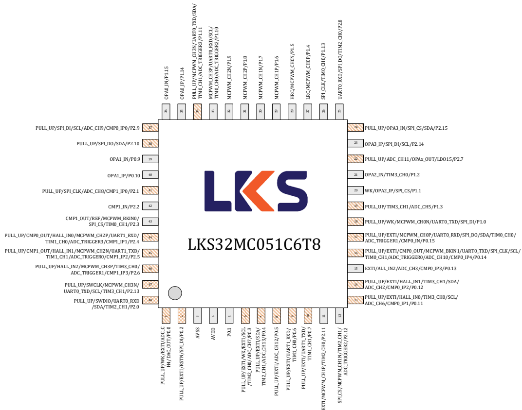
图 3-1 LKS32MC051C6T8 管脚分布图
