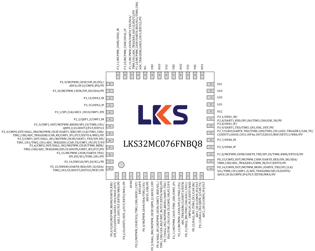
图 3-5 LKS32MC076FNBQ8 管脚分布图
