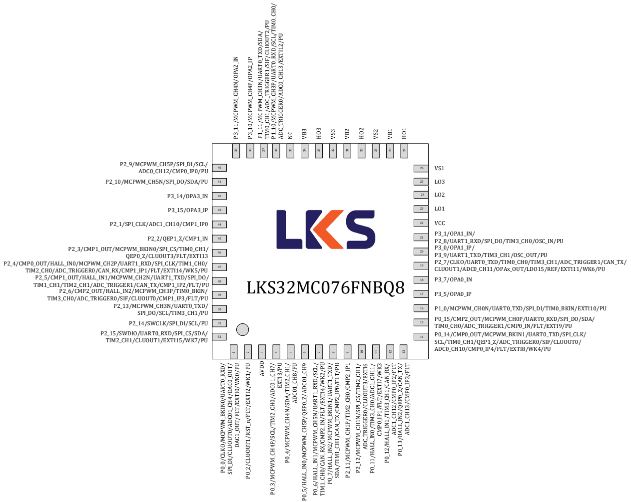
图 3-5 LKS32MC076FNBQ8 管脚分布图
