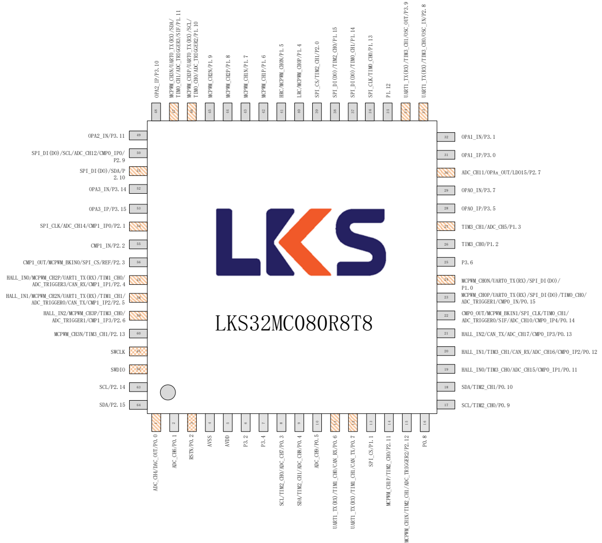
图 3-1 LKS32MC080R8T8 管脚分布图
