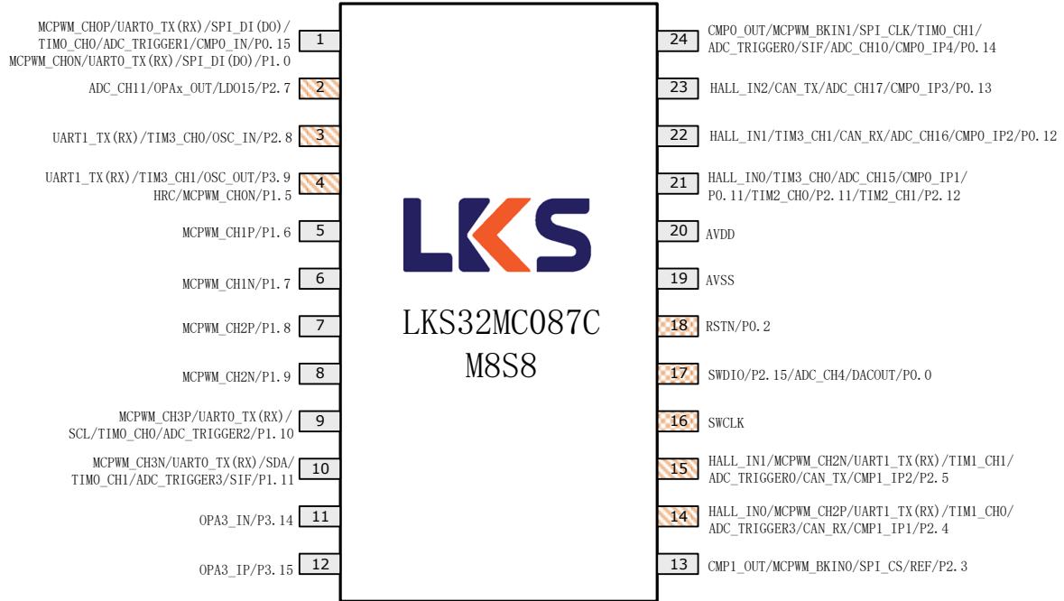
图 3-8 LKS32MC087CM8S8 管脚分布图
