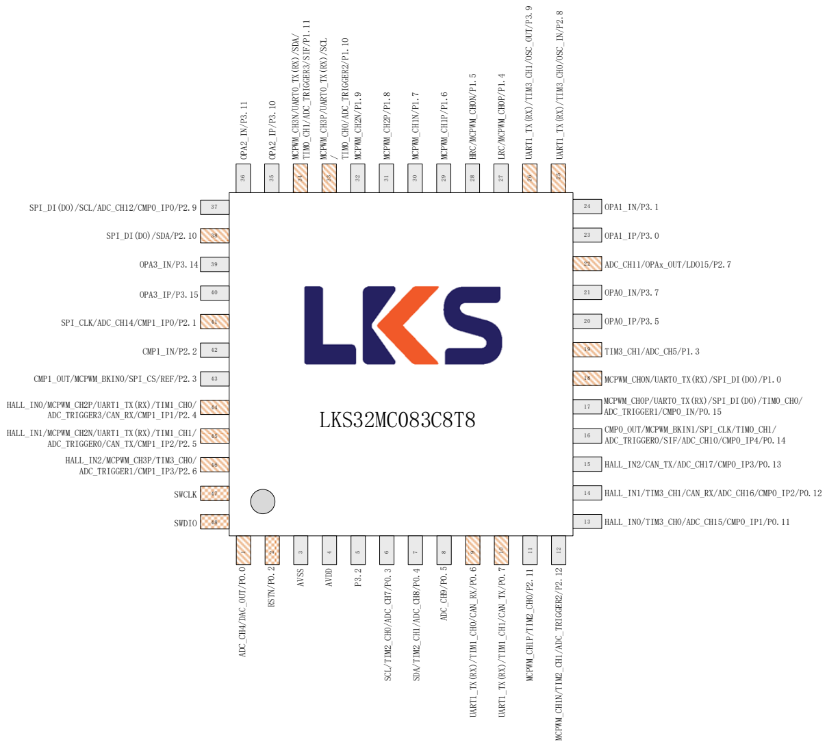
图 3-4 LKS32MC083C8T8 管脚分布图
