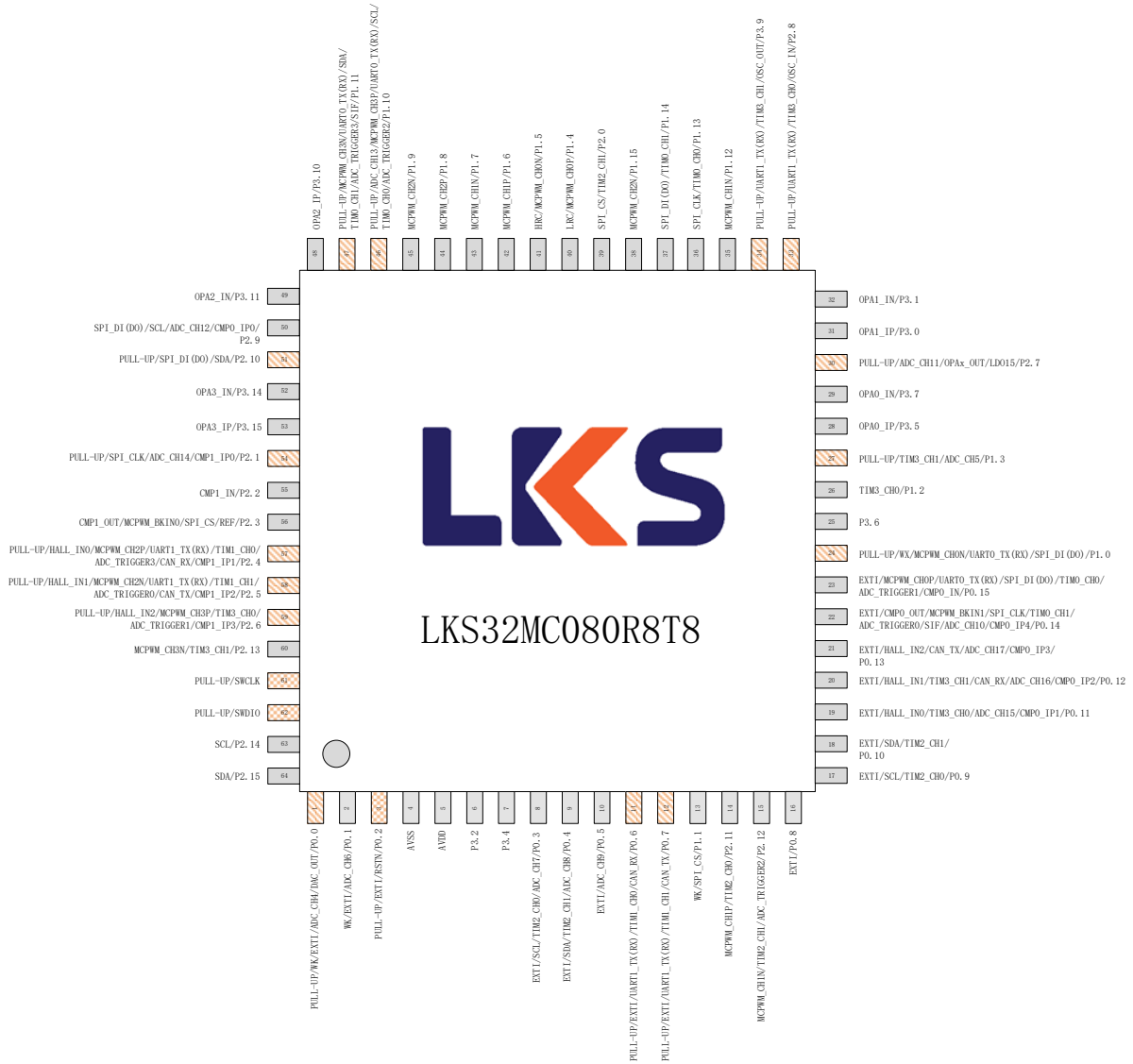
图 3-1 LKS32MC080R8T8(B)管脚分布图
