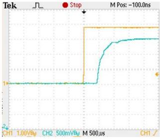
Start up Waveform CH<sub>1</sub>=V<sub>EN</sub>, CH<sub>2</sub>=V<sub>OUT</sub>
