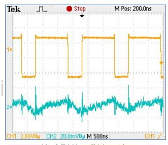
V<sub>IN</sub>=3.7V, V<sub>OUT</sub>=5V, I<sub>OUT</sub>=1A
