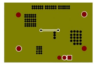
Bottom layer for LP6253HQVF Demo PCB Layout
