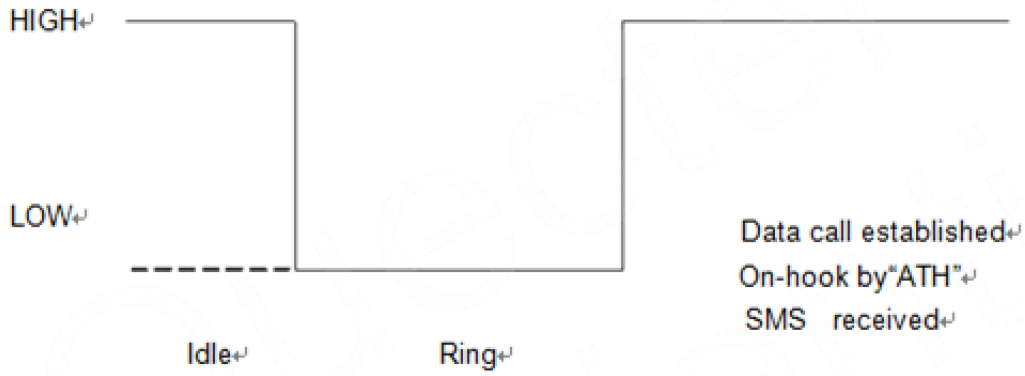
图表 15: 数据呼叫时模块用作被叫方 WAKEUP_OUT 时序
