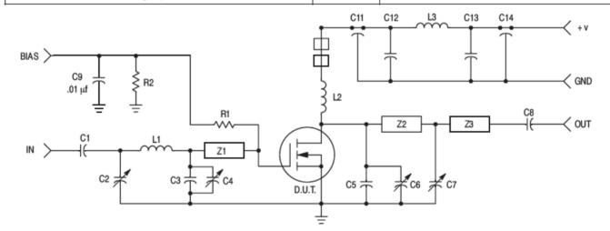
C1, C8 — 270 pF ATC Chip Cap C2, C4, C6, C7 — 1.0–20 pF Trimmer Cap C3 — 15 pF Mini Unelco Cap C5 — 33 pF Mini Unelco Cap C9, C12 — 0.1  $\mu$ F Ceramic Cap C11, C14 — 680 pF Feed Thru Cap C13 — 50  $\mu$ F Tantalum Cap
