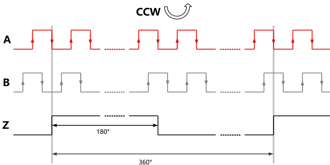
图-9 : Z脉冲宽度为180°时的ABZ输出
