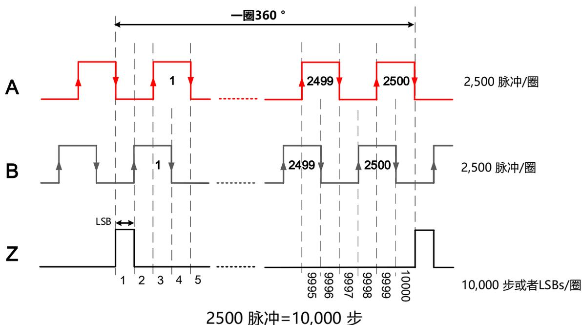
图-11: ABZ输出分辨率=2500 脉冲/圈
