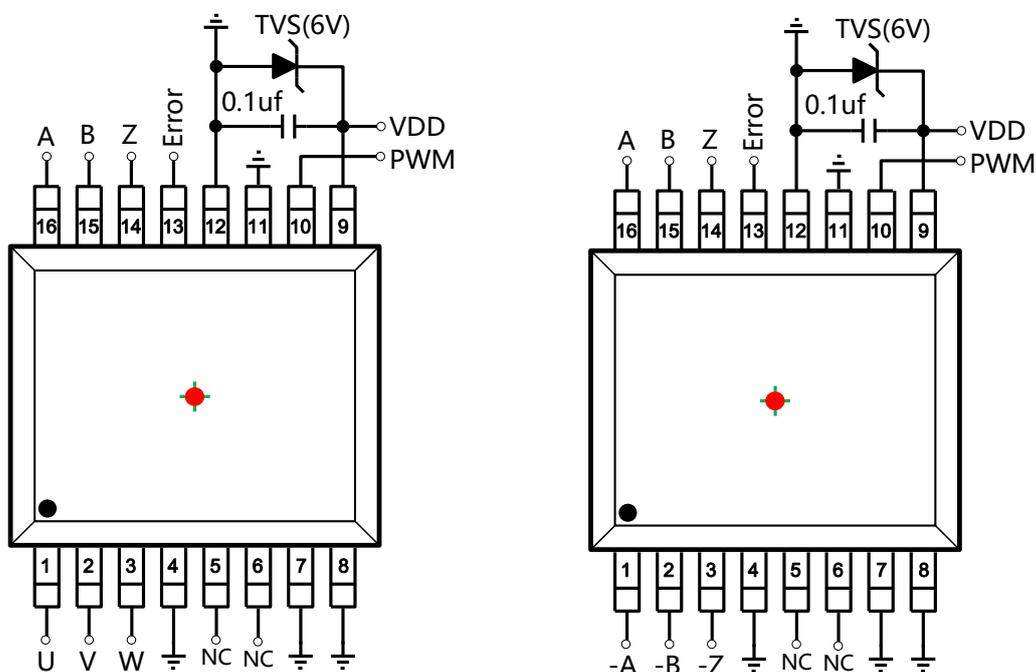
图-5: 不带MTP编程接口的ABZ, UVW和PWM参考电路
