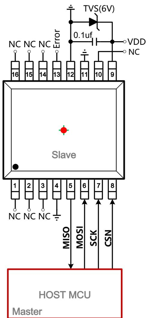
图-14：4线SPI参考电路
