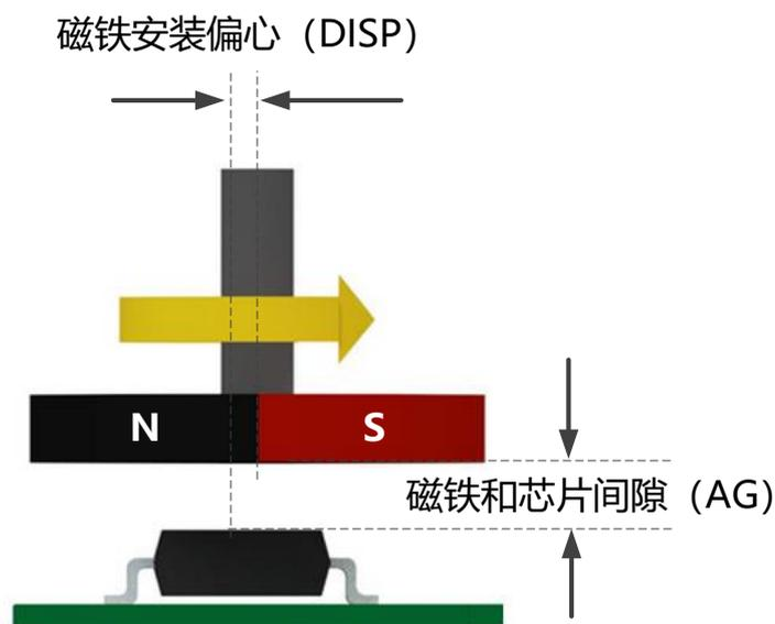
图-24: 磁铁安装
