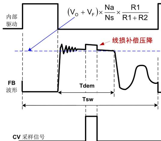
在恒压采样过程中，PWM1018Y 内部有一可变电流源从 FB 管脚流出用作线损补偿，由此将在 FB 波形上产生一电压阶梯。上图也展示了消磁过程中 FB 电压平台的量化关系：
