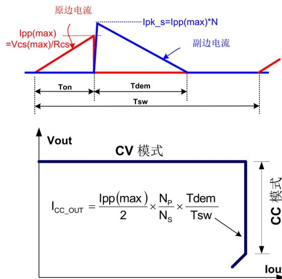
如上图所示，原边电感电流、变压器匝比、副边消磁时间 (Tdem) 和开关周期时间 (Tsw) 决定了副边平均输出电流。如果忽略漏感的影响，副边平均输出电流的公式在图 3 已示。当输出电流达到原边恒流控制模块的输出基准时，芯片将进入调频工作模式中，无论输出电压低于恒压输出基准或者具体如何，只要 VDD 电压不低于其关断电压芯片将持续工作。
