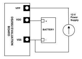
Figure 1: Connecting the DS2502 Evaluation Kit
