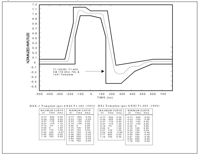
Figure 5-7. E1 Transmit Pulse Templates
