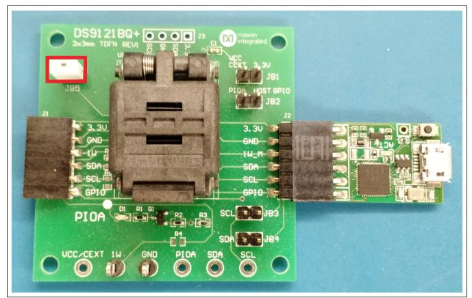
Figure 2. DS28E16 Connected to DS9481P-300#
