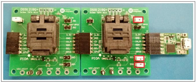
Figure 3. DS2477 Connected to DS9481P-300# and DS28E16
