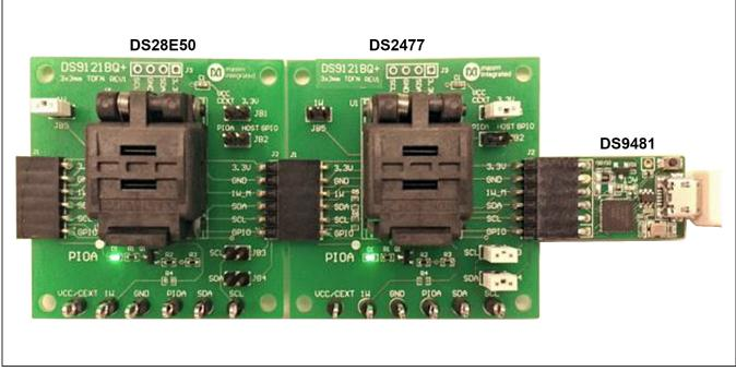
Figure 10. DS9481 Connected to DS2477 and DS28E50
