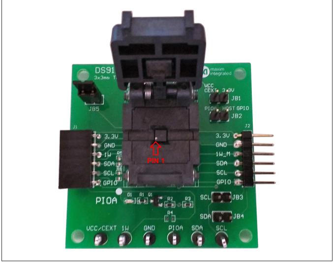
Figure 8. DS28E50 and DS2477 Orientation in Burn-In Socket
