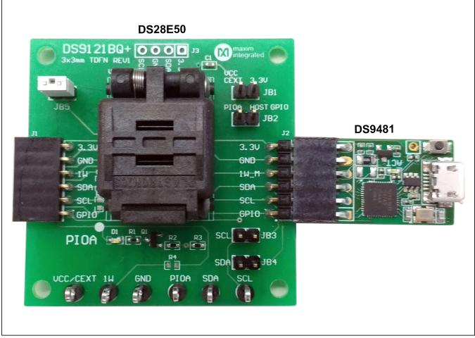
Figure 9. DS9481 Connected to DS28E50
