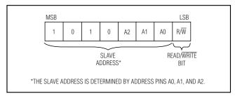
Figure 2. DS4420 Slave Address Byte
