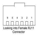
Figure 5. <u>i</u>Button SOCKET FOR DS9490B
