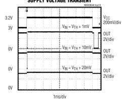
POWER-SUPPLY REJECTION FOR NO FALSE TRIGGERING
