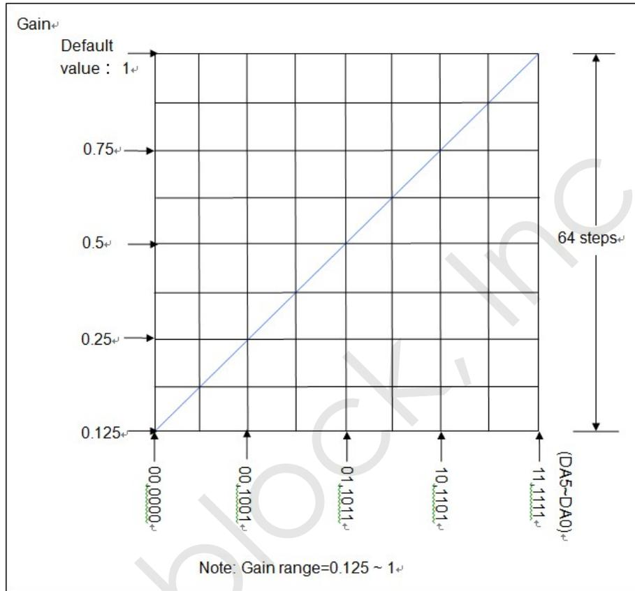
状态缓存器的第 5 到第 0 位是用来设定输出端的电流增益，总共有六位可以用来设定 G 值，范围从 6'b000000 到 6'b111111，使用者可以设定 64 阶的电流增益。这些位可以更进一步再状态缓存器中定义：
