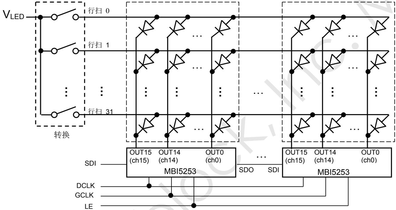
上图显示扫描行数为 32 行扫描屏所建议的应用架构图。由 LE 与 DCLK 组成的指令，可透过 SDI 与 SDO 脚位来传送灰阶数据。16 个输出通道(OUT0 ~ OUT15)会在不同时间点传递 PWM 数据给每个扫描行数，因此必须具备时间多任务操作的开关给每行之扫描。开关切换顺序与操作方式将在下个单元中描述。
