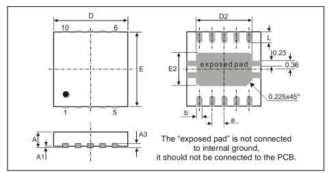
Fig. 7: 10L QFN 3x3 Dual
