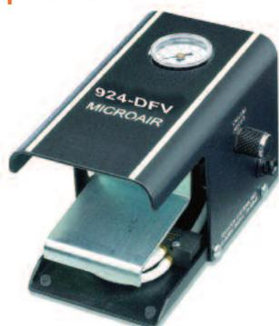
La gamme de doseurs à valve avec contrôleur au pied 924-DFV offrent un double avantage : une production accrue et une économie du doseur. Montés au sol, ils disposent d'un régulateur de pression intégré, d'un manomètre et d'une valve à trois voies à vidage rapide. Le débit de sortie et la taille de la dépose sont contrôlés par l'opérateur.
