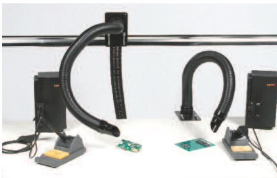
Die BVX-Arme (50 mm Ø) stellen eine preiswerte Lösung dar. Sie vereinen gute Absaugleistung mit großer Flexibilität. Aufgrund des spiralförmigen Aufbaus der Arme können diese durch Drehen verfestigt und präzise positioniert werden. Über einen Y-Adapter können zwei BVX-Arme an einen Lufteinlass der MFX-Systeme angeschlossen werden. So ist es möglich, bis zu acht Arbeitsplätze mit einem Absaugsystem zu verbinden.
