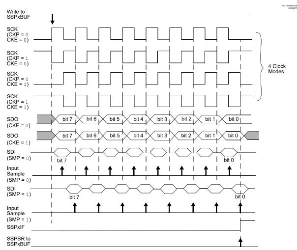
Figure 27-4. SPI Mode Waveform (Master Mode)
