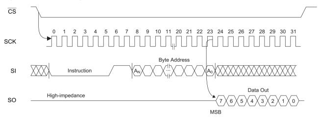
Figure 7-7. WRITE Timing
