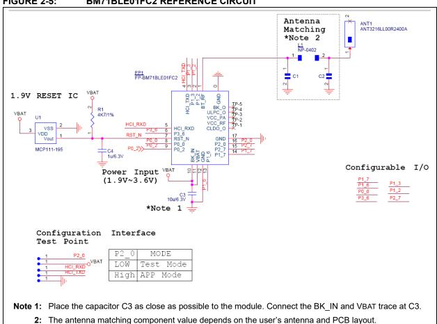
FIGURE 2-6: BM71BLE01FC2 REFERENCE CIRCUIT
