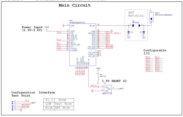
FIGURE 2-4: **BM70BLE01FC2 REFERENCE CIRCUIT**
