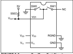
FIGURE 3-5:  $T_{ON}/T_{OFF}$  Test Circuit.
