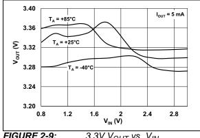
FIGURE 2-9: 3.3V V<sub>OUT</sub> vs. V<sub>IN</sub>.
