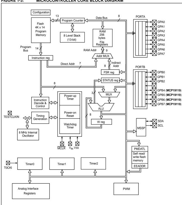
FIGURE 1-3: MICROCONTROLLER CORE BLOCK DIAGRAM
