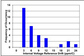
FIGURE 2-37: V<sub>REF</sub> Drift Data Histogram Chart.
