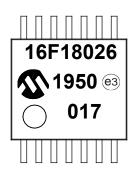
14-Lead SOIC (3.90 mm)
