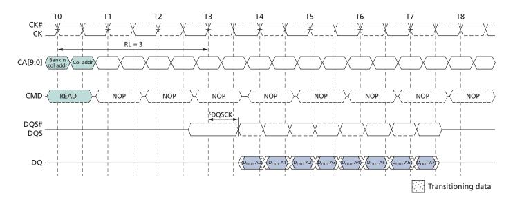
Figure 16: <sup>t</sup>DQSCKDL Timing
