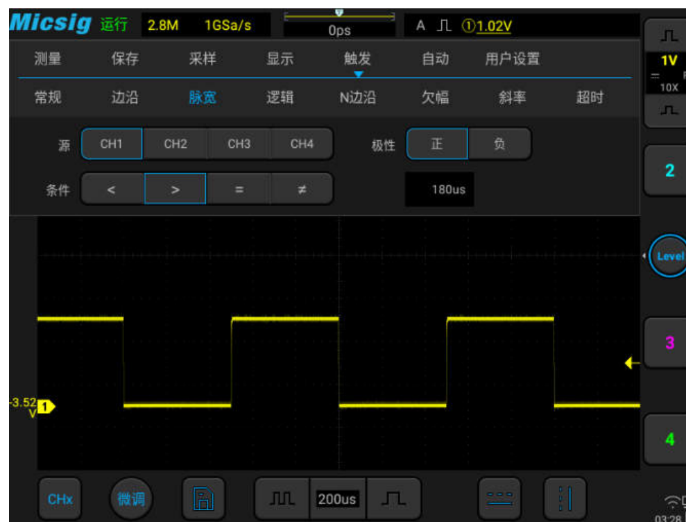
图6-14 脉冲宽度触发设置菜单
