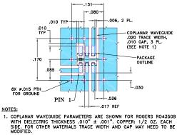
BOTTOM SIDE OF THE PCB IS CONTINUOUS GROUND PLANE. DENOTES PCB COPPER LAYOUT WITH SMOBC (SOLDER MASK OVER BARE COPPER).
