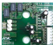
Super mini DIIPM™ evaluation board EVA11-SDIP
